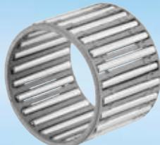
Igličasti kavez obuhvata neodvojiv kavez i iglice i može da se koristi za dizajniranje veoma kompaktnih, lakih konstrukcija sa maksimalnim kapacitetom. Osovina i kućište služe kao kotrljajuća staza i mora biti obrađena u skladu sa tvrdoćom, geometrijom i karakteristikama hravrosti. Iglice su precizno vođene, i zato igličasti kavez može da apsorbuje mnogo veći broj obrtaja od punog reda iglica.
