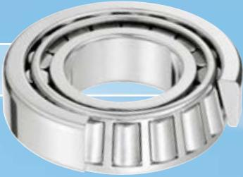
Ovi ležaji trpe visoka radijalna i aksijalna opterećenja u jednom smeru. Obično se ugrađuju suprotno okrenuti ležaju istog tipa. Nivo opterećenja zavisi od ugla dodira.
