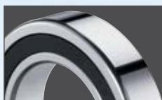
Gumene zaptivke fiksirane na spoljašnjem prstenu, bez kontakta sa unutrašnjim prstenom, mogu da se koriste da se održi maksimalna brzina kao kod otvorenog ležaja, podmazanog mašću.
